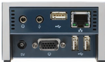
Типовая задняя панель простого удлинителя KVM IP
