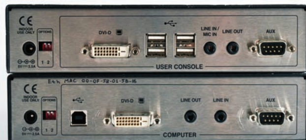
Панели разъемов комплекта ALIF1000P
